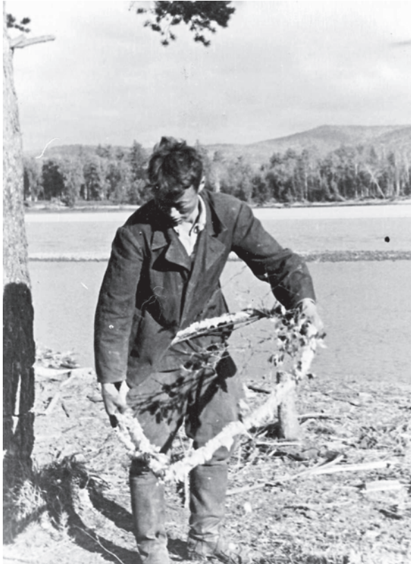
Рис. 57. «Кольцо» для связывания плотов. Тоджа, 1952 г. Сытыг-хемский леспромхоз, лесочасток Солчур р. Пий-хем [фото из рукописи Е.Д. Прокофьевой]
