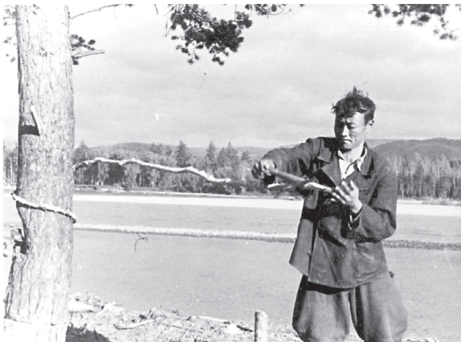
Рис. 55. Витые «кольца» для сплачивания плотов. Сытыг-хемский леспромхоз, лесоучасток Солчур р. Пий-хем [фото из рукописи Е.Д. Прокофьевой]
