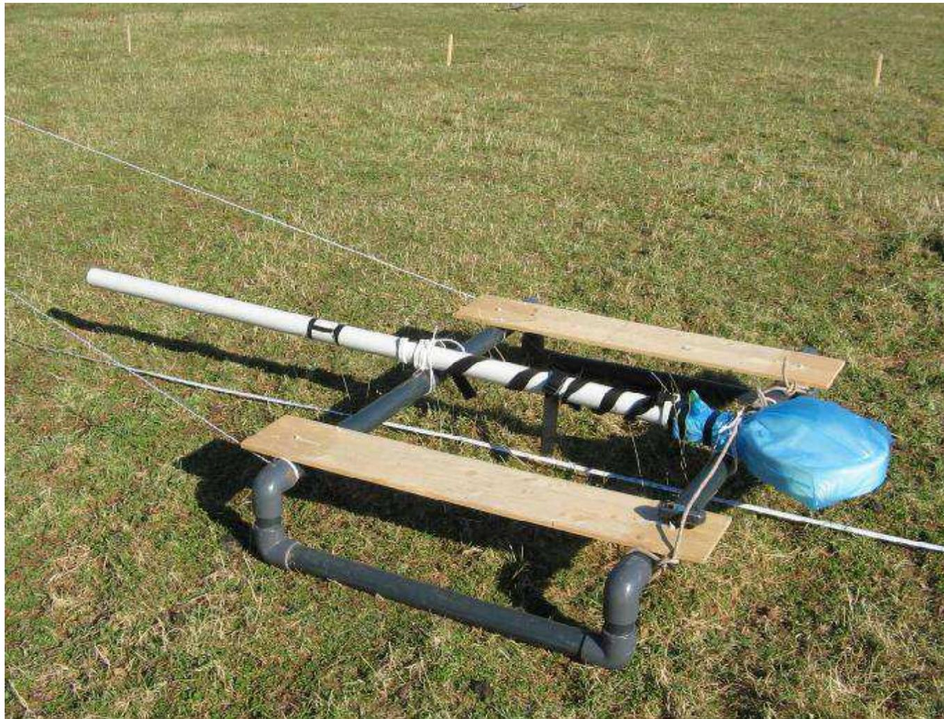
**Рис. 4.** Аппаратура ЭМС, закрепленная на санках.
