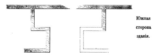
Масштабъ чертежа 20 ф. въ дюймѣ; незаштрихованныя части чертежа возстановлены и въ натурѣ представляють только кучи щебня. Толщина стѣнъ 4 ф.
