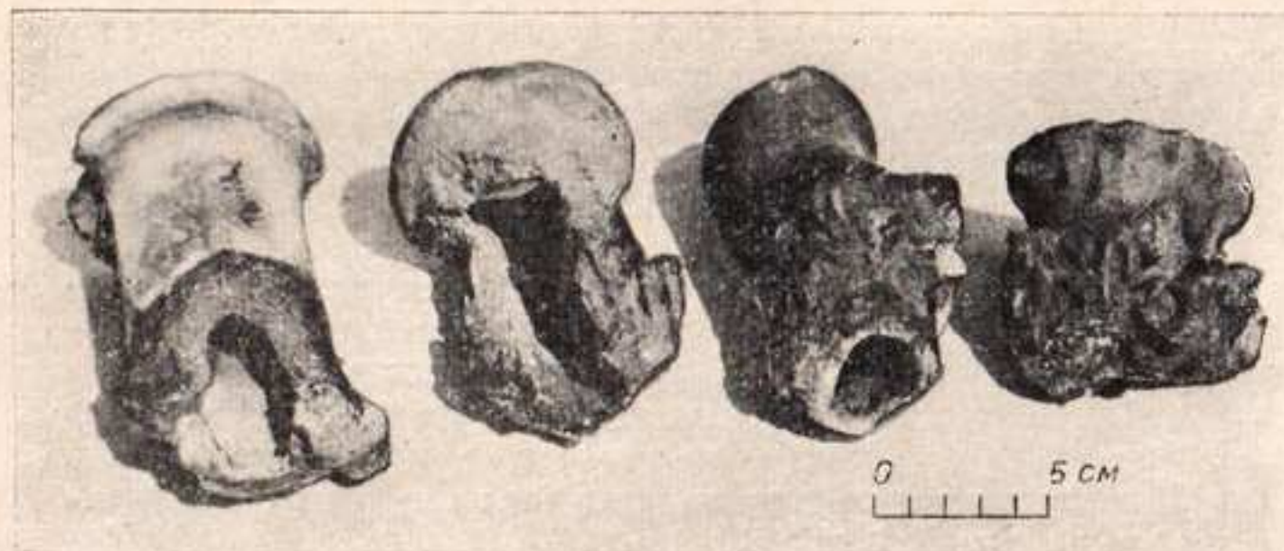
Рис. 22. Воздуходувные сопла с ошлакованными концами.
